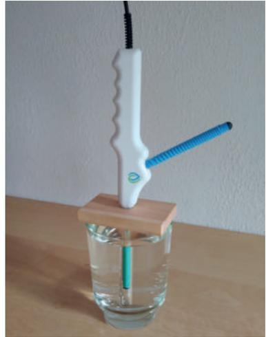
Sollte die Handsonde einmal nass werden, trocknen Sie diesen sorgfältig mit einem Tuch ab. Hat die Ummantelung einer Antenne Schäden, nutzen Sie die Handsonde nicht mehr und tauschen diese aus.
